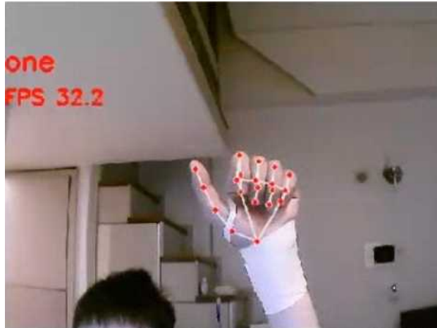
그림 9. 손목 보호대를 써서 제스처 one의 식별 테스트 Fig 9. Test gesture one's identification using wrist guards
