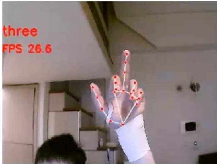
그림 11. 손목 보호대를 써서 제스처 three의 식별 테스트 Fig 11. Test gesture three's identification using wrist guards
