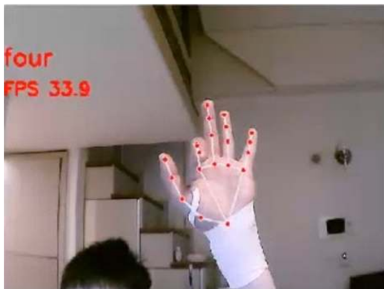
그림 12. 손목 보호대를 써서 제스처 four의 식별 테스트 Fig 12. Test gesture four's identification using wrist guards
