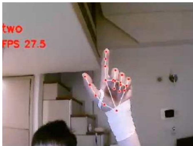
그림 10. 손목 보호대를 써서 제스처 two의 식별 테스트 Fig 10. Test gesture two's identification using wrist guards
